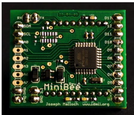
SenseStage est une infrastructure logicielle et matérielle intégrée dont l'usage est intuitif pour les artistes et les designers, qui peut travailler à l'échelle de plusieurs noeux, et qui performe l'acquisition de données, la transmission, le conditionnement, le partage et les tâches de composition grâce à un même système.
